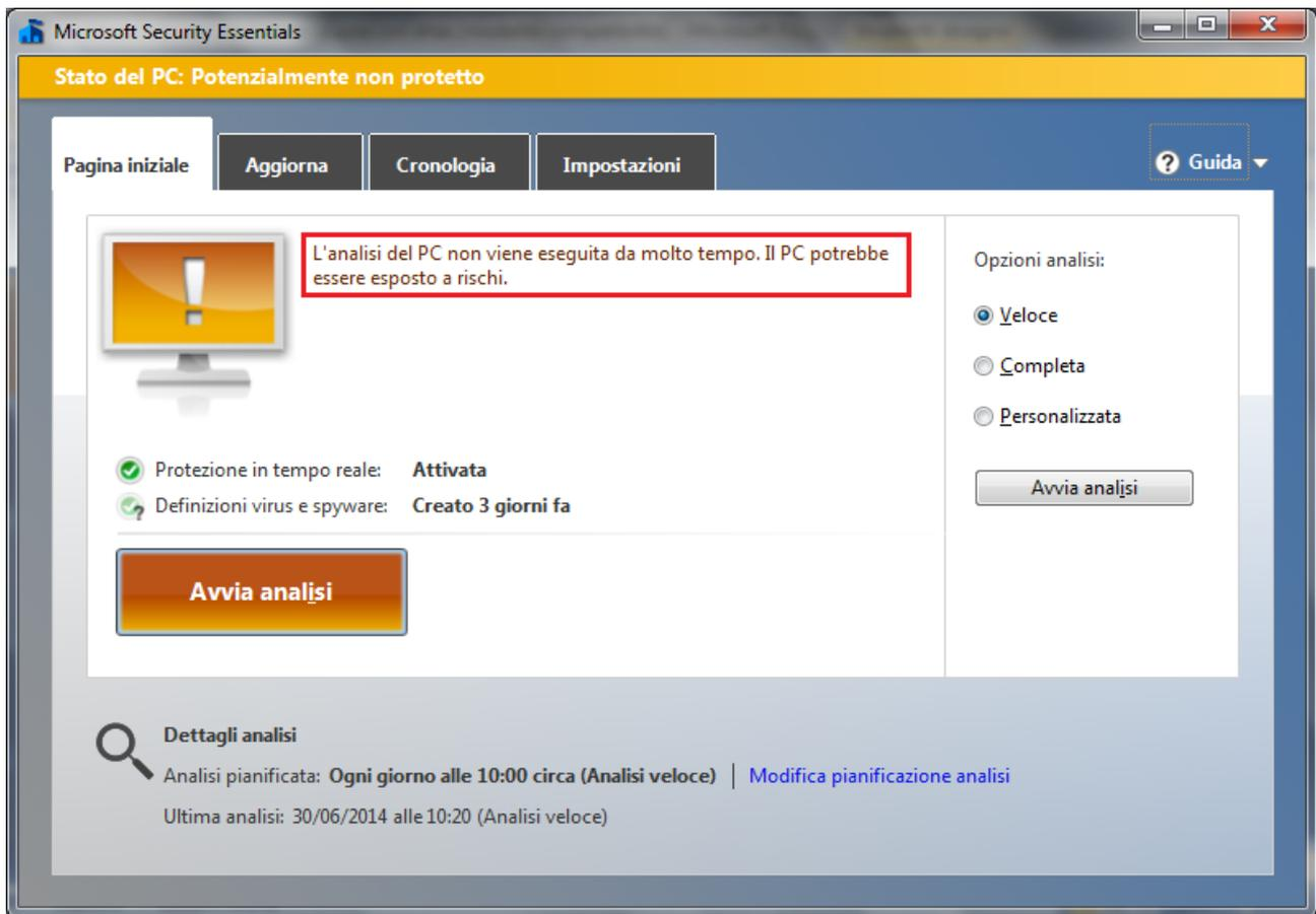
Da qui si possono avviare tutte le operazioni. In figura, il programma segnala che è da molto tempo che non viene effettuata una scansione manuale. Per avviare la scansione premere il pulsante **Avvia analisi**.
